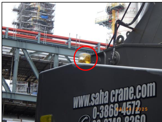
รูปที่ 2-69 ไฟสัญญาณที่ท้ายเครื่องจักร
