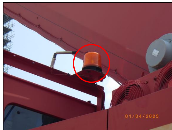
รูปที่ 2-69 ไฟสัญญาณที่ท้ายเครื่องจักร
